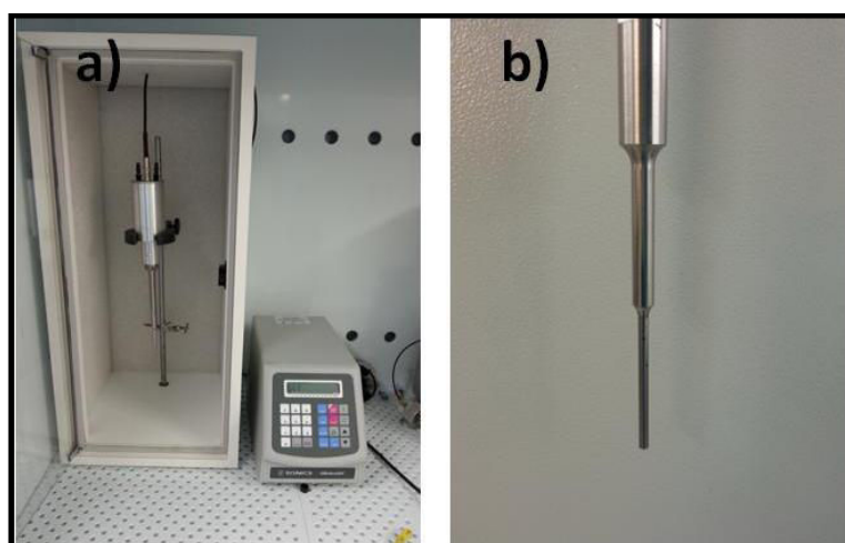
Figure II-6. Photographie du Vibra-Cell 750 de chez Sonics (a) et photographie de la sonde de 2 mm délivrant les ultra-sons dans le milieu réactionnel (b).
