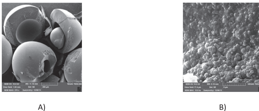
Figure 11. Clichés de microscopie électronique à balayage d'une microparticule coupée de structure cœur-écorce (poly(acrylamide)– poly(TPGDA))(A) et de l'intérieur de sa matrice montrant des nanoparticules de poly(MMA-co-TPGDA) à 50:50 (B). Débit de la phase continue, 130 \mu\text{L}/\text{min} , de la phase intermédiaire (écorce), 4 \mu\text{L}/\text{min} et de la phase interne (cœur), 1.5 \mu\text{L}/\text{min} .
