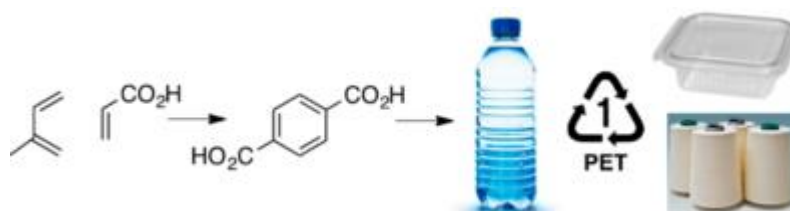
Figure 86 : valorisation de la réaction de Diels-Alder dans une alternative aux produits issus de la pétrochimie 343
