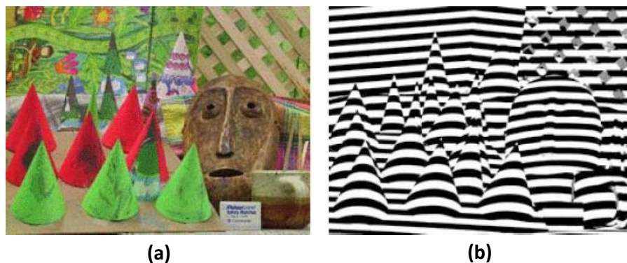
Figure 1.12 – Projection de lumière structurée Si un motif connu est projeté sur une surface (a), et que celle-ci est imagée sous cet éclairage, les déformations du motif correspondent à la topographie de la surface. Le motif projeté peut être un nuage de points, des bandes, un damier, des cercles, etc. et permet d'acquérir la totalité de la surface en une seule fois. La méthode la plus utilisée consiste à projeter des franges, ce qui donne après post-traitement, l'image (b) extraite de [Scharstein et Szeliski, 2003].
