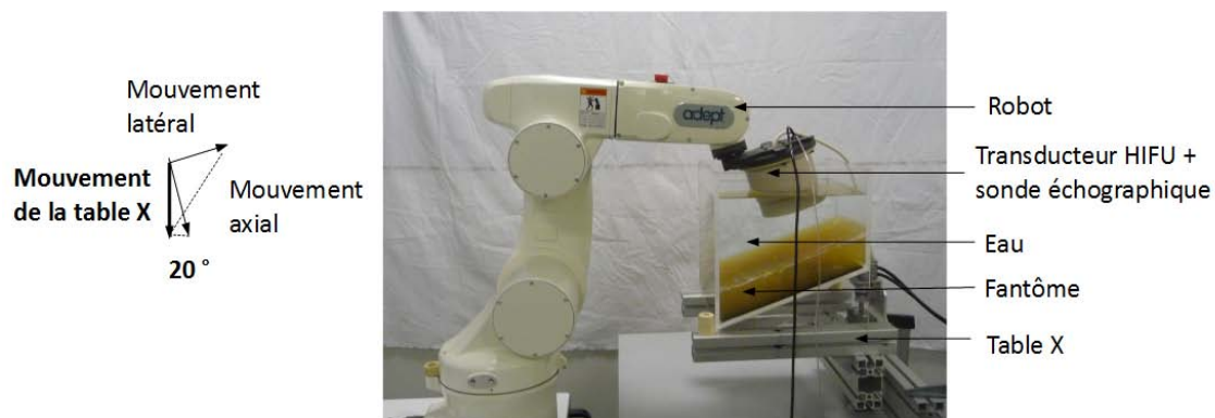
Figure 3.16 : expérience de compensation 2D.
