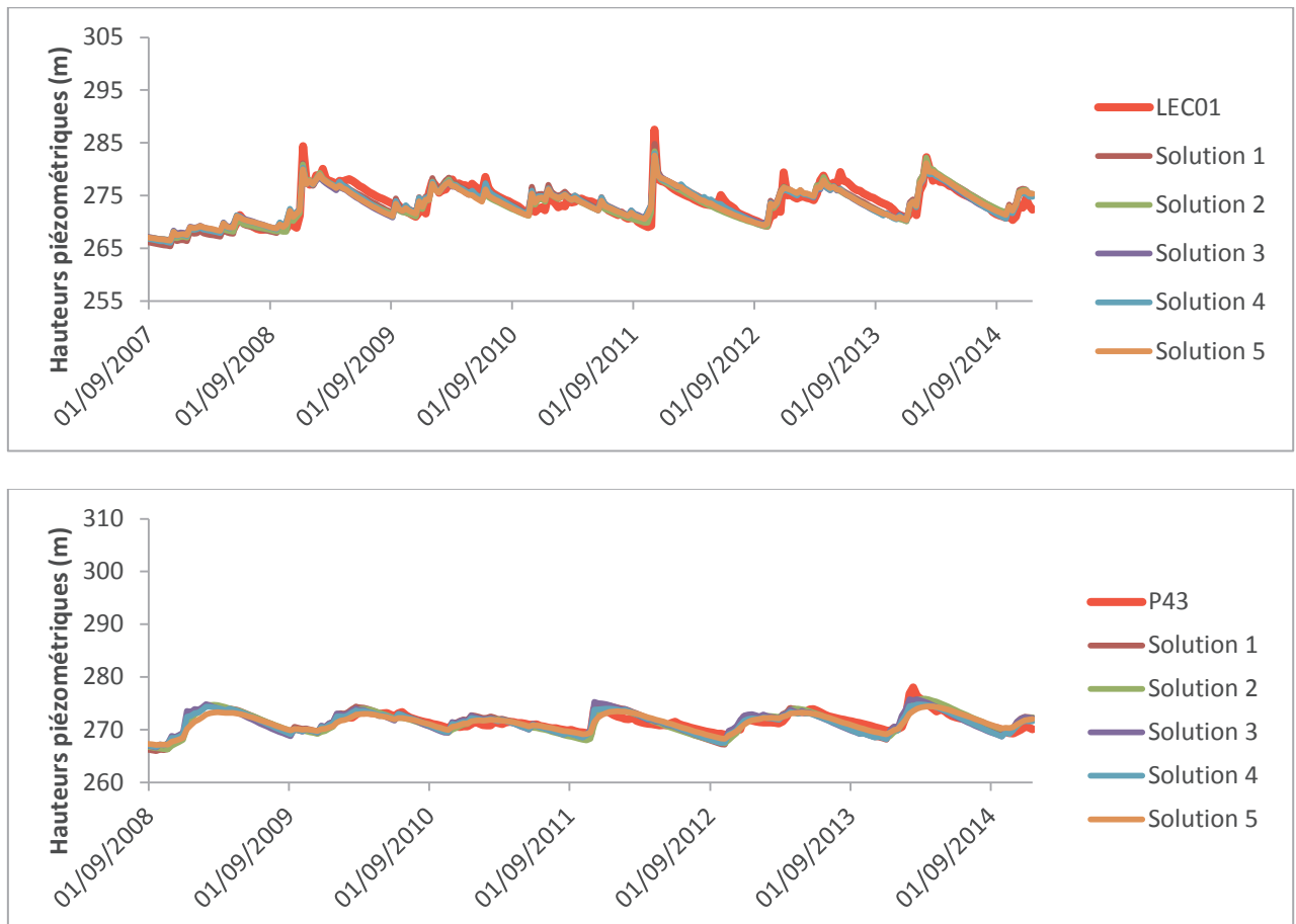
Figure 39 : Comparaison entre chroniques piézométriques simulées et celles mesurées aux piézomètres LEC01 et P43
