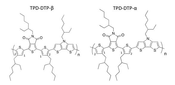
**Figure 1**: Les structures chimiques des polymères TPD-DTP- $\beta$  (gauche) et TPD-DTP- $\alpha$  (droite). Les positions 1 et 2 sur les thiophènes correspondent aux  $\alpha$  et  $\beta$ , respectivement.
