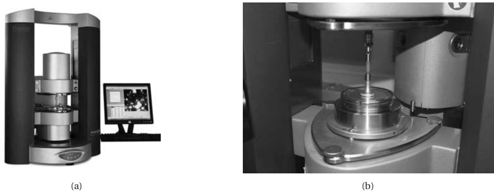
Figure D.2 – Rhéomètre dynamique HAAKE™ MARS™ de ThermoFisher Scientific : (a) ensemble du dispositif; (b) zoom sur la zone d'intérêt pendant les expériences.
