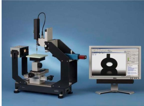
Figure II. 25. Analyseur de profil de goutte. *source www.kruss.de*
