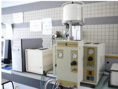
Figure II. 16. Appareil SETARAM TG-DTA 92-16
