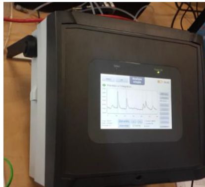
Figure IV- 1 Photographie du prototype industriel en cours de fonctionnement au laboratoire. Injection de 5 ppb de BTEX.
