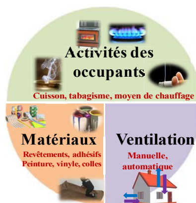
Figure I- 5 Schéma représentant les différentes sources d'émission de BTEX en air intérieur.
