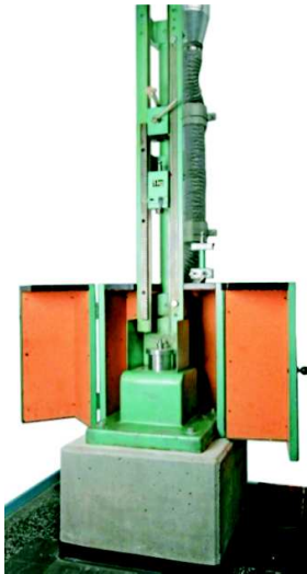
(a) Julius Peters Bundesanstalt für Materialprüfung (BAM) Fall-Hammer for impact test
