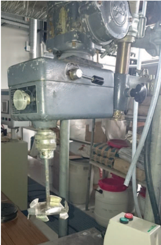
Figure 50 : pale défloculeuse réalisée au laboratoire
