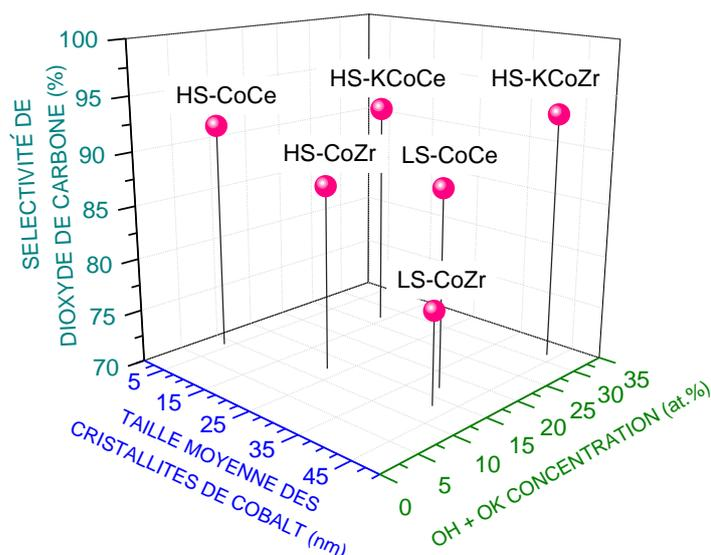
**Fig. 5** Influence de la taille des cristallites de cobalt et de la concentration de groupes contenant les atomes d'oxygène (exprimé en pourcentage atomique) sur la sélectivité des catalyseurs supportés par l'oxyde de cérium et zirconium dans la production du dioxyde de carbone ( $H_2O/EtOH = 12/1$  mol/mol,  $420^\circ C$ ,  $t = 1$  h).
