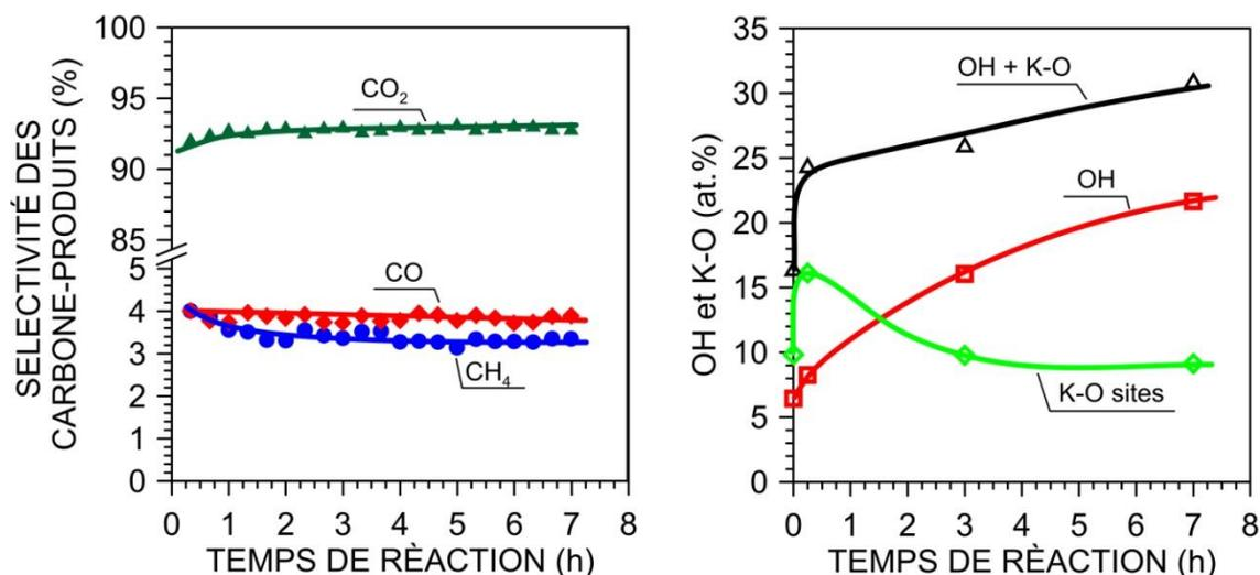
**Fig.2** Influence du temps de la réaction d'ESR sur la sélectivité vers les produits de carbone et impact du changement de la concentration des groupes OH et KO sur le catalyseur supporté au cérium, promu par le potassium ( $H_2O/EtOH = 12/1$  mol/mol,  $420^\circ C$ ,  $p = 57$  mbar).
