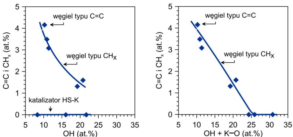
**Rys. 3** Korelacja procentowego stężenia (w procentach atomowych) węgla typu C=C oraz CH<sub>x</sub> ze stężeniem grup hydroksylowych (lewy wykres) i sumą grup OH + K–O (prawy wykres) na powierzchni katalizatorów z nośnikiem cerowym.
