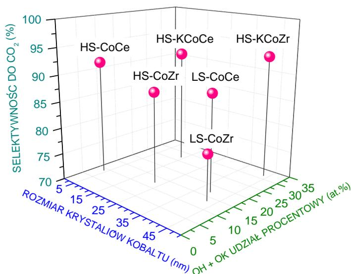
**Rys. 5** Wpływ rozmiaru krystalitów kobaltu i ilości grup zawierających atomy tlenu (wyrażony w procentach atomowych) na selektywność ESR w kierunku tworzenia dwutlenku węgla na katalizatorach z nośnikami cerowymi i cyrkonowymi ( $H_2O/EtOH = 12/1$  mol/mol,  $420^\circ C$ ,  $t = 1$  godz.).
