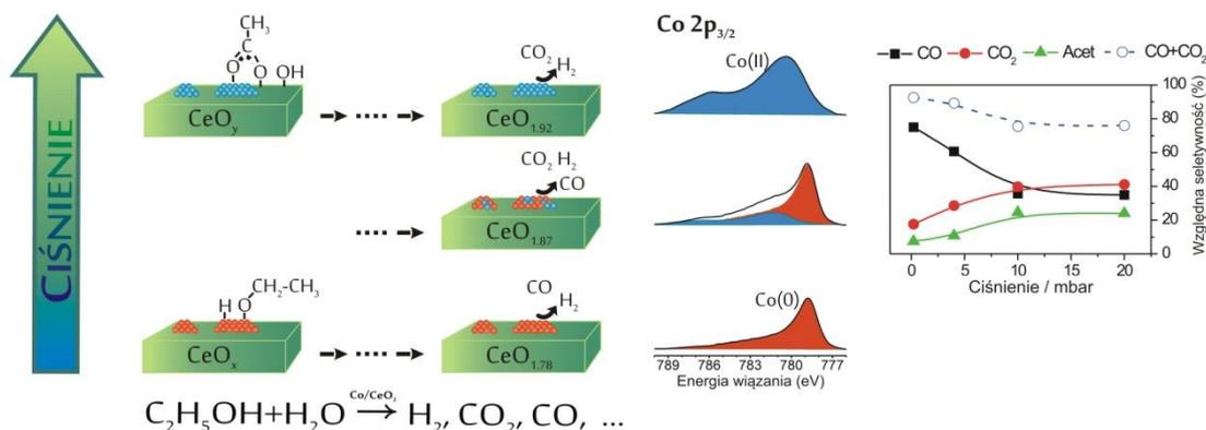
**Rys. 1** Wpływ ciśnienia (0.2–20 mbar) na stan powierzchni i dystrybucję produktów węglowych (HS-Co/CeO<sub>2</sub>, H<sub>2</sub>O/EtOH=3/1 mol/mol, 420°C).
