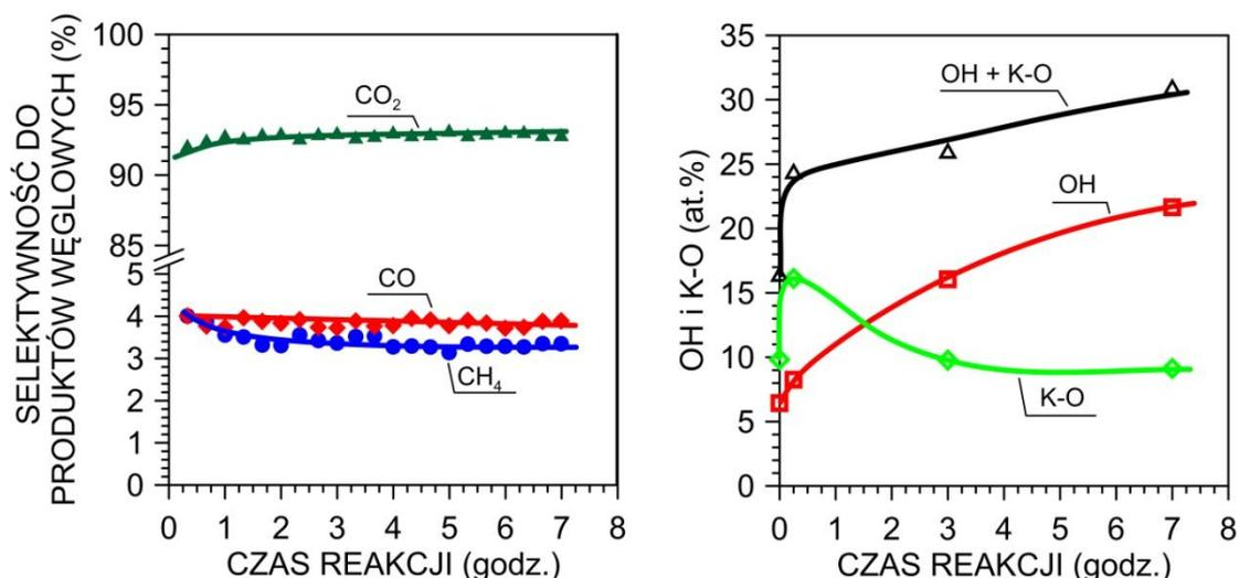
**Rys. 2** Wpływ czasu reakcji ESR na selektywność do produktów węglowych oraz na zmiany procentowej ilości grup OH i miejsc K–O na promowanym potasem katalizatorze z nośnikiem cerowym ( $H_2O/EtOH = 12/1$  mol/mol,  $420^\circ C$ ,  $p_{częściowe} = 57$  mbar,  $p_{całkowite} = 1$  atm).
