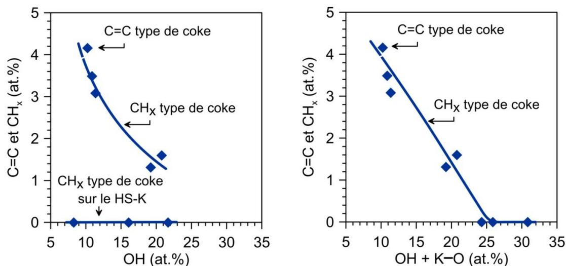
**Fig. 3** Corrélation de la contribution des groupes C=C et CH<sub>x</sub> (en pourcentage atomique), de la concentration des groupes hydroxyles et de la somme de groupes OH + K–O sur la surface du catalyseur supporté à l'oxyde de cérium.
