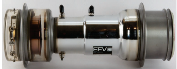
Figure I-19 : Tube type P855C utilisé dans les caméras Imacon-500 (Giorgio)
