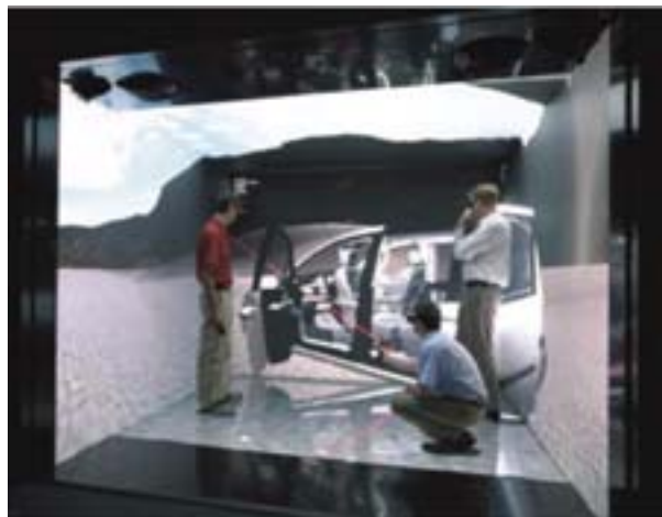
FIGURE 1.7: Exemple d'une séance de travail entre les concepteurs sur le design extérieur d'un modèle de véhicule. La visualisation tridimensionnelle immersive du modèle se fait dans un CAVE avec une projection sur cinq face.
