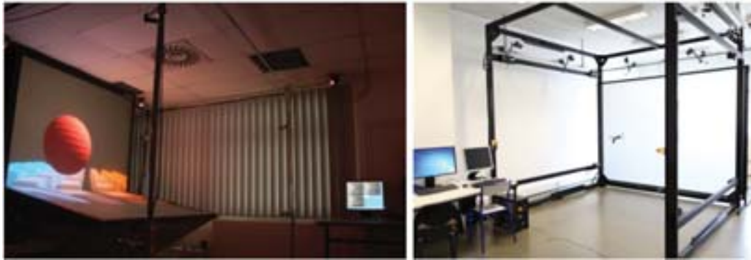
FIGURE 3.2: Les dispositifs d’affichage de la plateforme de réalité virtuelle IN VIRTUO . Image de gauche représente le Workbench. Image de droite représente le mur immersif
