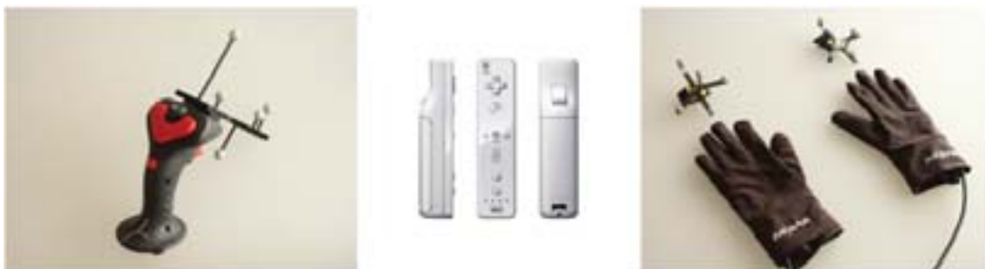
FIGURE 3.3: Les périphériques d’interaction de la plateforme de réalité virtuelle IN VIRTUO . De gauche à droite : le flystick, la Wii et les gants de données.
