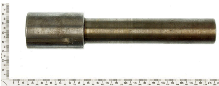
Vue du canon utilisé pour tirer des munitions du type .308W et ou .243 W modifiées pour tirer des billes en acier de 8 mm, avec ou sans fausse cartouche à feuillette.
