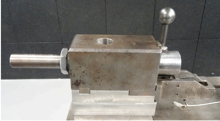
Vue d'un canon de calibre .308 W dont l'âme du canon a été réalésée à un diamètre de 8 mm exactement.
