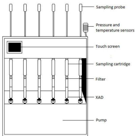
**Figure 13.** Schéma d'un échantillonneur actif d'air à faible volume conçu pour l'échantillonnage intérieur (d'après MonAirNet, 2007)
