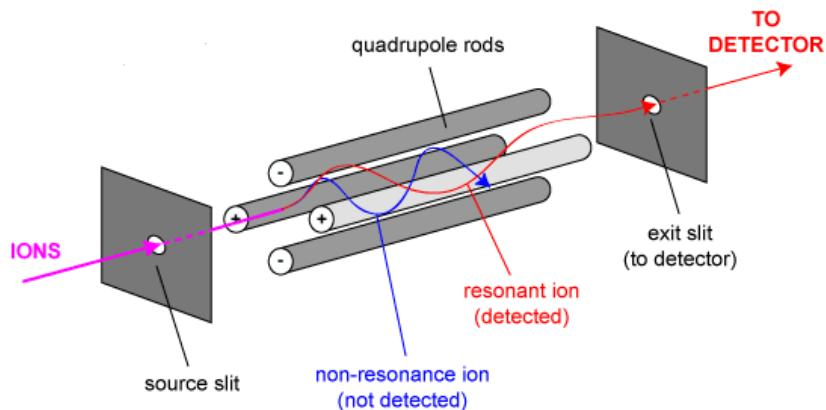
Figure 25. Schéma d'un analyseur quadripolaire (d'après Yinon, 2007)
