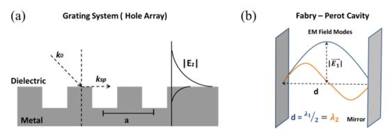
**Figure 2.** (a) Représentation schématique du couplage d'un système de réseau avec une périodicité a, indiquant la direction du vecteur  $k_{sp}$  du moment du plasmon de surface. Le champ électrique évanescent ( $E_z$ ) à l'interface métal-diélectrique est représenté par la ligne noire sur le côté droit de la figure. (b) Exemple schématique de l'amplitude des premier et deuxième modes de cavité Fabry-Pérot (FP) confinés entre deux miroirs métalliques parallèles.
