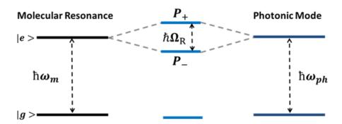
**Figure 1.** (a) Représentation schématique du couplage fort d'une transition moléculaire d'énergie  $\hbar\omega_m$  et d'une résonance optique d'énergie  $\hbar\omega_{ph}$  formant les états hybrides P+ et P- séparés par l'énergie de séparation de Rabi  $\hbar\Omega_R$ .
