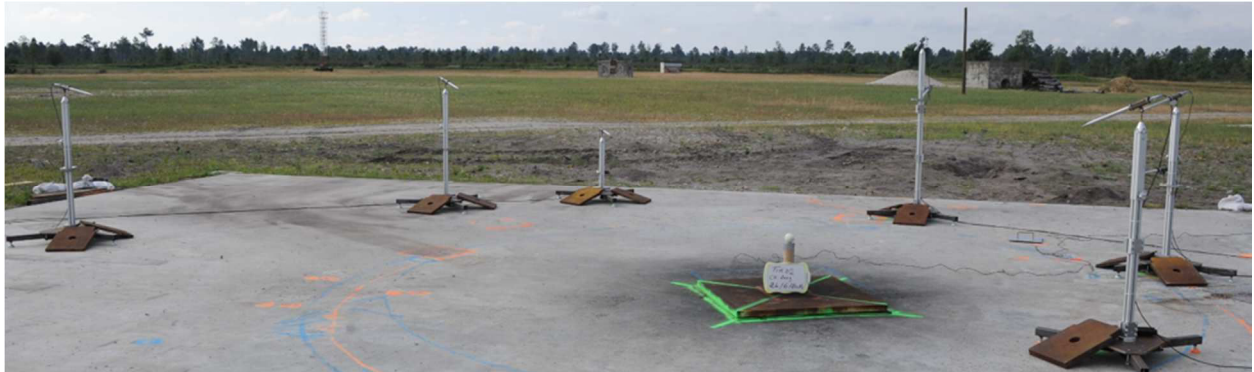
Figure 2.1 : Vue globale de la scène expérimentale sur laquelle on peut y voir les sondes effilées et leurs supports ainsi que la plaque d'acier située sous la charge explosive.
