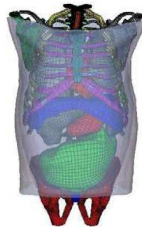
Figure 1.49 : MEF du torse humain par Thoral-Pierre et al. [2012] développé pour comprendre la réponse sous dynamique rapide – appelé HUBYX
