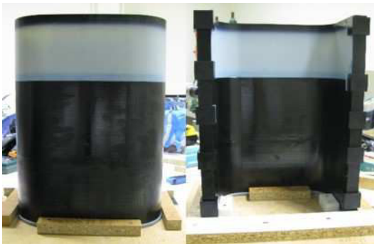
Figure D- 2 : Moule du RIG réduit réalisé à l'aide de l'impression 3D. Il comporte 22 pièces.
