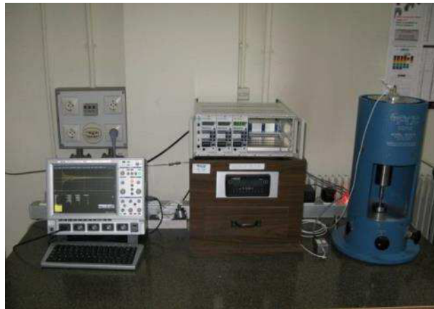
Figure A- 1 : Illustration du banc de calibration PCB, modèle 907A02.
