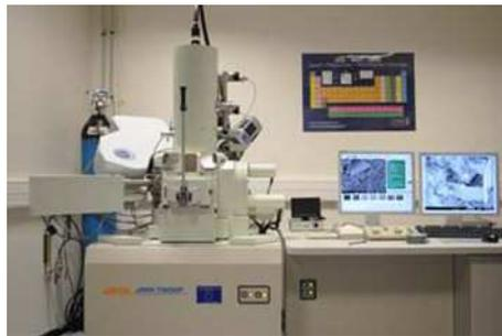
Figure A4.4: MEB JSM-67000F de JEOL.
