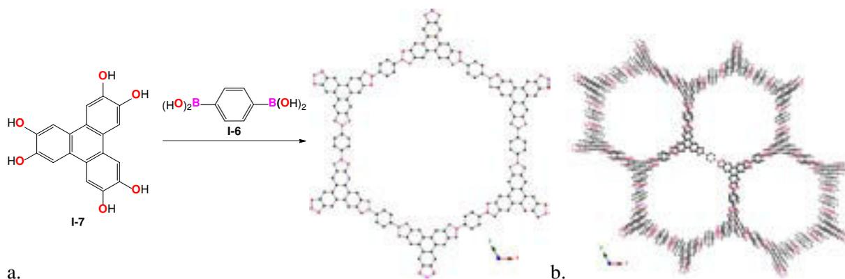
Fig. 26. Schéma de synthèse de **COF-5** et structure cristalline montrant le réseau hexagonal formé (a) et les cavités formées par l'empilement éclipsé des feuillets (b)<sup>62</sup>. Les atomes d'hydrogène ont été omis par souci de clarté.
