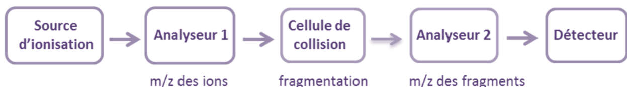
Figure 8: Représentation schématisée d'un spectromètre de masse en tandem
