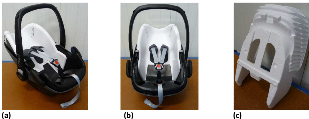
Figure 81 – Matériaux d'absorption d'énergie de la coque dos à la route : (a) vue de trois-quart ; (b) vue de face ; (c) insert en polystyrène expansé
