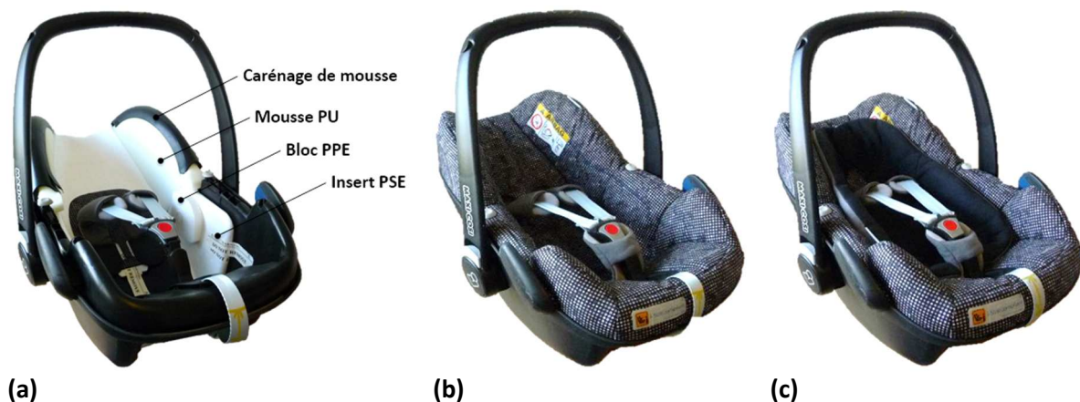
Figure 173 – Dispositif de retenue optimisé vis-à-vis de la réglementation 129 : (a) coque et matériaux d'absorption d'énergie ; (b) avec la mousse de confort ; (c) avec la mousse de confort et le coussin réducteur
