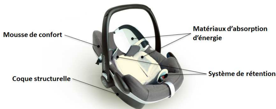
Figure 46 – Principaux éléments constituant un dispositif de retenue pour enfants
