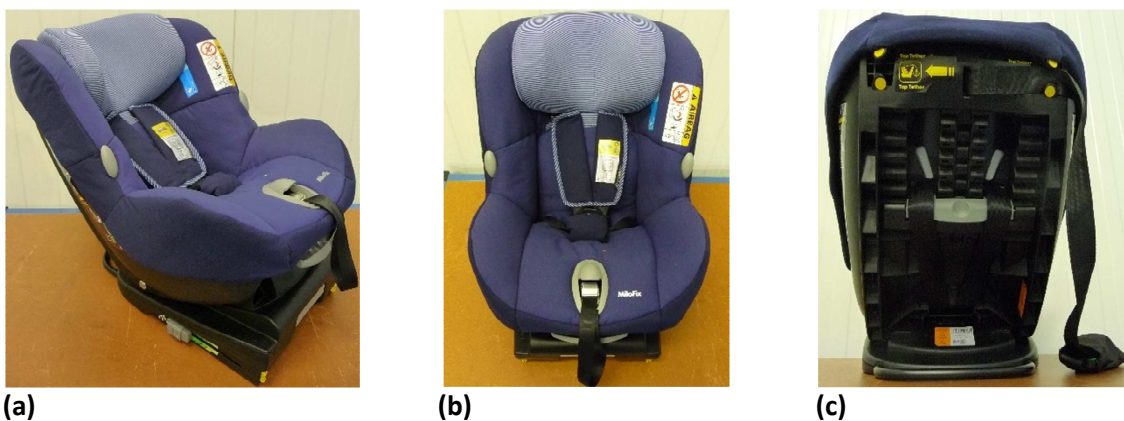
Figure 83 – Dispositif de retenue réversible en position dos à la route : (a) vue de trois-quart ; (b) vue de face ; (c) vue arrière
