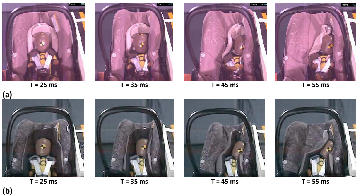
Figure 174 – Cinématique du mannequin Q0 lors des essais de choc latéral pour : (a) le siège-auto de référence ; (b) le siège-auto optimisé (vue de droite)
