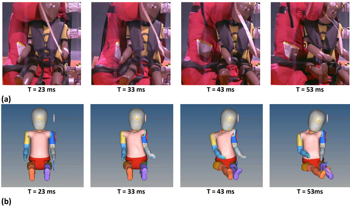
Figure 128 – Comparaison de la cinématique du mannequin Q1 : (a) l'essai de référence avec le système à colonnes (vue de droite) ; (b) simulation numérique avec le modèle (vue de droite)
