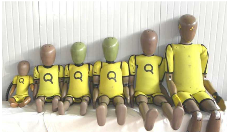
Figure 49 – Famille de mannequins Q. De la gauche vers la droite : Q0, Q1, Q1.5, Q3, Q6 et Q10
