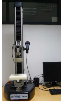
Figure 183 – Machines de caractérisations de matériaux : (a) mono-colonne NS1 utilisée en quasi-statique ; (b) puits de chute utilisé en dynamique
