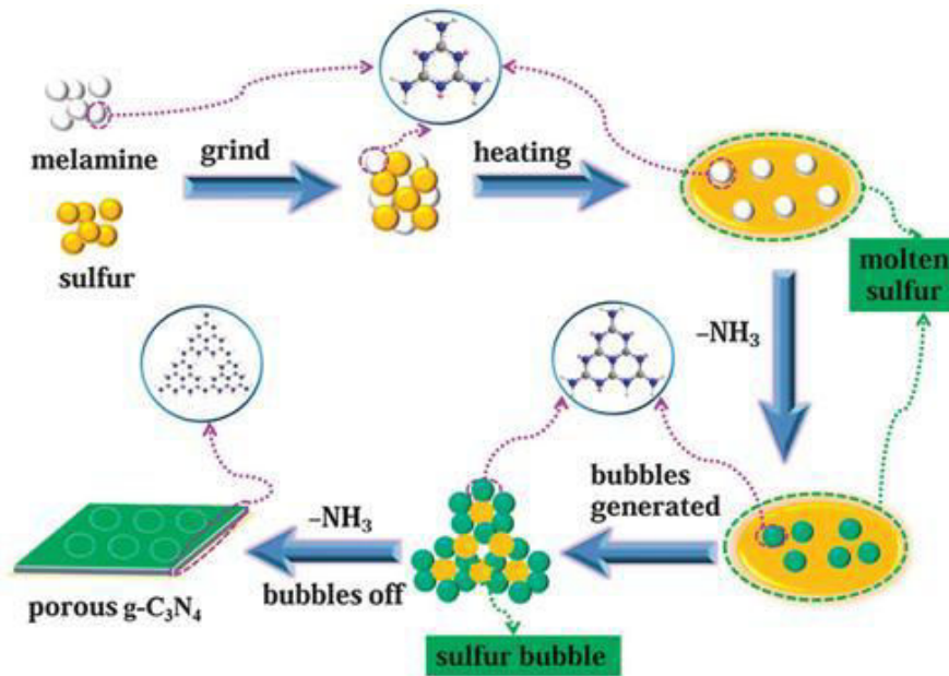
Figure A.25 : Illustration schématique de la synthèse de gC 3 N 4 poreux en présence de sulfures [111]
