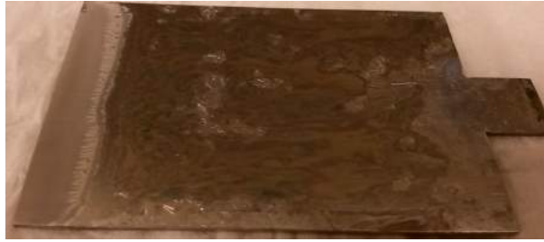
Figure 94 – Photo d'une électrode "brûlée" après avoir été pré-anodisée dans la cellule électrochimique de 150 ml avec une distance inter-électrode de 10 mm et une épaisseur de paroi en téflon W = 2 mm. Ce phénomène a été observé lorsque la température de l'électrolyte dépasse 70^\circ\text{C} .
