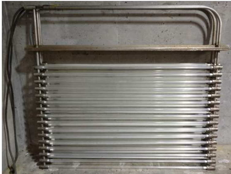
Figure 27 – Photo d'un ensemble de 50 lampes UV-C basse pression en Hg provenant de la station d'épuration des eaux usées de Québec (baie de Beauport). Caractéristiques : longueur d'un tube UV-C \approx 1,55 m ; prix d'un tube \approx 20\$ ; durée de vie de 1 an ; utilisation 4 mois par an (été) ; période totale d'utilisation 3 ans. Nombre total de lampes dans la station = 4640. I_0 = 1,7 mW/cm 2 . Source : Service du traitement des eaux de la ville de Québec
