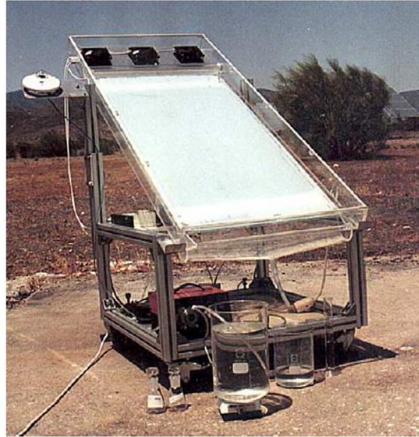
Figure 22 – Réacteur photocatalytique pilote avec film mince en \text{TiO}_2 [135].
