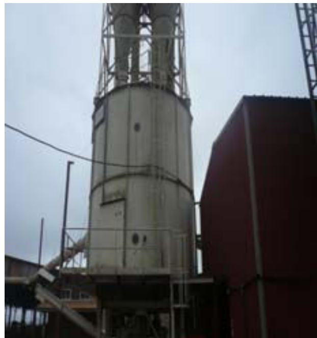
Photos 36 et 37: Chaudière utilisant des déchets de bois issus des activités de transformations et cellules pour le séchage du bois.
