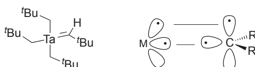
Schéma 2. Carbène triplet de type Schrock.
