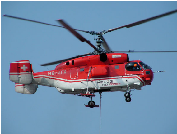
Figure 1.11 – L'hélicoptère "gros porteur" Kamov Ka-32 appartenant la compagnie Heliswiss, pouvant soulever jusqu'à 5 tonnes de charge utile.
