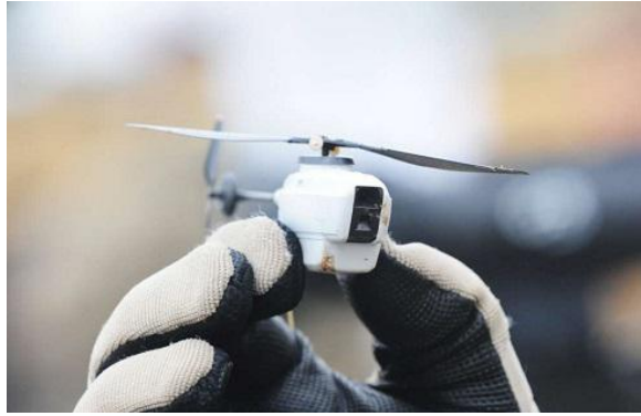
Figure 1.5 – le PD-100 “Black Hornet” développé par Prox Dynamics (Norvège) (racheté par FLIR Systems, USA, fin 2016), utilisé par l’armée britannique depuis 2012 puis par l’armée de nombreux autres pays depuis (Seck, 2016). C’est un hélicoptère miniature de 12 cm d’envergure. Il pèse 18 g avec ses trois caméras et a une endurance de 20 à 25 minutes. Il est capable de vols par points de passage GPS.
