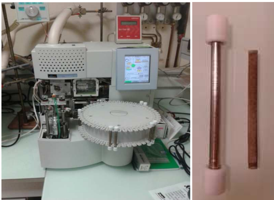
Figure III-2 : Appareillage de thermodésorption (ATD) (à gauche) et tube de thermodésorption et capteur Tenax (à droite)
