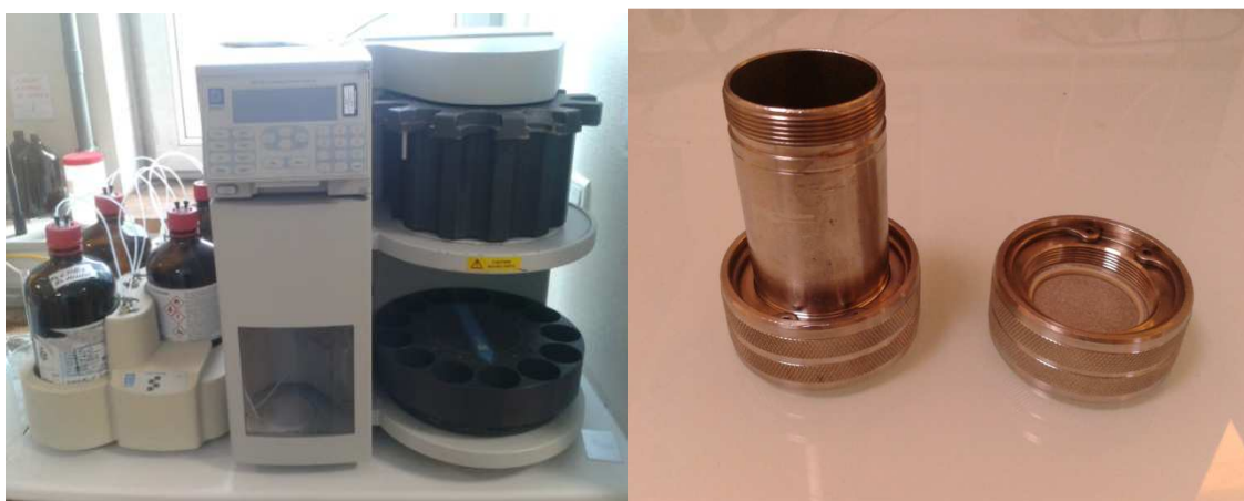
Figure III-1 : Dispositif d'extraction accélérée par solvant (ASE) (à gauche) et cellule d'extraction (à droite)
