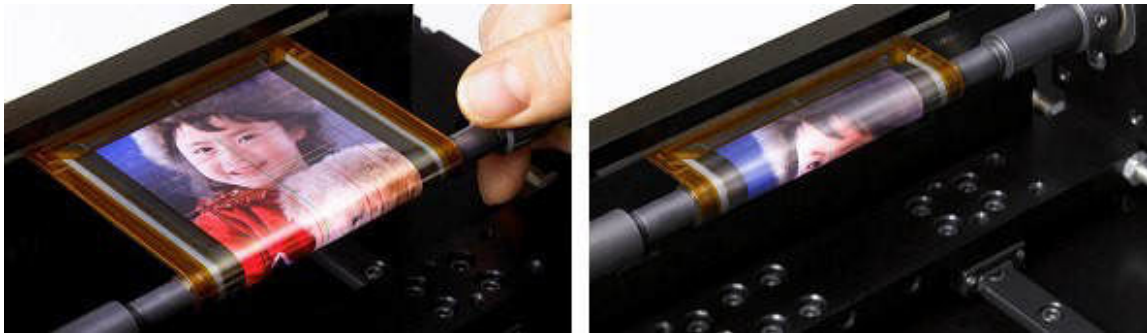
FIGURE 1.1 : Illustration d'un flexible. Démonstration de l'utilisation de matériaux organiques dans la conception d'écrans flexibles. Photos issues de la réf. 13.
