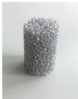
Figure V.5 : Mousse métallique en aluminium utilisée.
