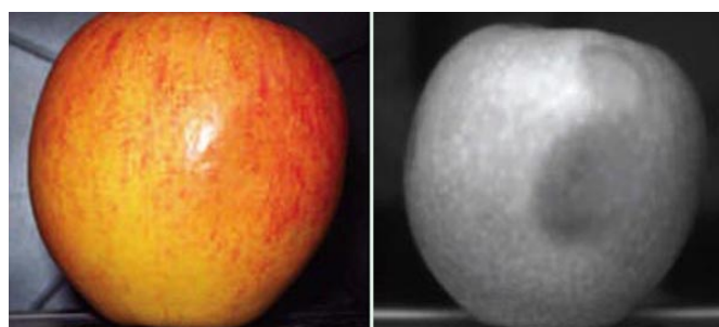
FIGURE 1.10: Comparaison imagerie visible/SWIR pour une pomme. A gauche l'image visible, à droite l'image SWIR. Une zone plus sombre apparaît sur la pomme en SWIR, mettant en évidence un problème de conservation. D'après [28]
