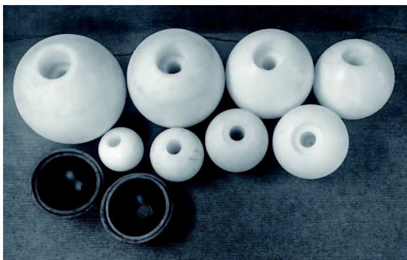
FIGURE 2.6. – 8 sphères de Bonner et leurs demi-sphères de plomb [CFK16]
