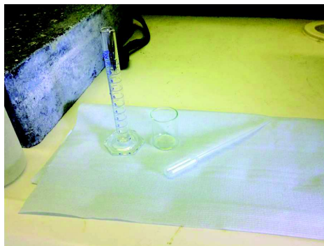
FIGURE B.4 – Épiprouvette graduée, récipient et pipette utilisée pour prélever le HCl
