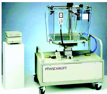
FIGURE 4.5 – Exemple de cuve à eau et de son dispositif de fixation de la chambre d’ionisation (PTW©Water Phantom)
