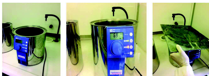
FIGURE B.3 – Cuve chauffante de forme cylindrique utilisée pour l'attaque chimique (bain chauffant avec agitation magnétique HBR4 Digital IKA)
