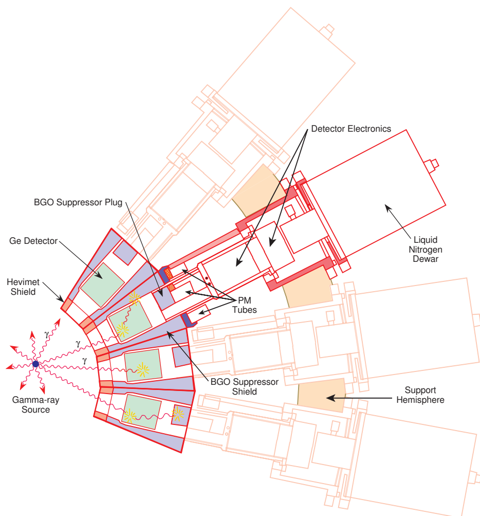
FIGURE II.3 – Schéma en coupe d'une partie de Gammasphere [80, 81].
