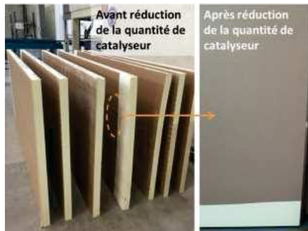
Figure SI 72: exemple de panneaux de mousses PUIR issus de l'essai à l'échelle du pilote industriel
