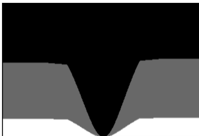
Figure 3.11: Profil du filtre papillon reconstruit. L'aluminium est en blanc, le PMMA est en gris et le noir représente l'air.
