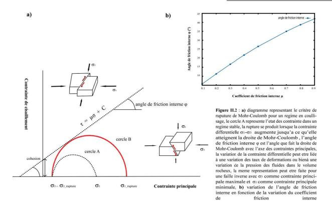
En tenant en compte l'angle de friction interne dans le processus de rupture d'une roche, une rupture de type cisaillement se produira si la ligne de rupture est tangente au cercle défini par les contraintes principales (Figure II.1.c, Figure II.2a). Par conséquent, l'angle α par lequel le plan de rupture est orienté par rapport à la direction de la contrainte principale maximale est associé à quatre possibilités de fracture (de 1 à 4), il est donnée par :
