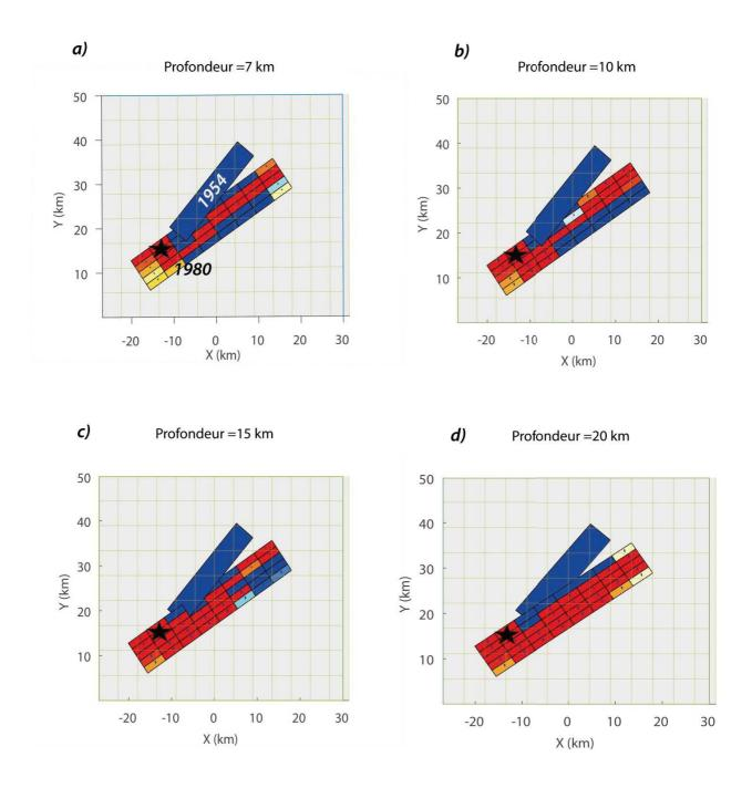
Figure 2 : Modélisation △CFF associée au séisme d'Orléansville du 09/09/1954( Mw=6.7) pour différente profondeur : a) profondeur hypocentrale=7km, b) profondeur hypocentrale=10km, c) profondeur hypocentrale=15km, d) profondeur hypocentrale=20km.
