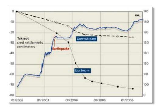
**Figure V.16**: Tassement en crête en rapport avec le remplissage du barrage de Taksebt avant et après le séisme de Zemmouri du 21 Mai 2003 (Mw =6.9), la figure montre une accélération du tassement du barrage à terre de Taksebt avant le séisme de Zemmouri. La figure montre aussi que
