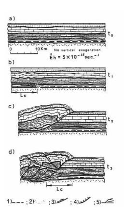
Figure V.3: Déformation interne et cycle sismique associé aux failles inverses dans un régime transpressive selon Cello and Nur (1988): 1) future détachement, 2) pression des pores aux limites hydrostatiques, 3) failles actives, 4) champ de fracturation dilatant.
