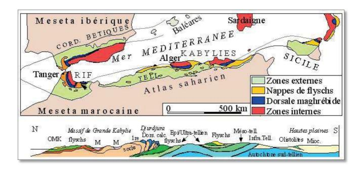
**Figure I.2**: Carte structurale schématique de la chaîne des Magrébides montrant la disposition des zones internes et externes et coupe simplifiée sur la transversale de la grande Kabylie, (d'après Delga & Fontboté, 1960).
