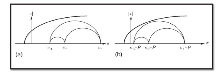
**Figure II.7:** *a)* état de contrainte pre-rupture, *b)* l'application de la pression des pores met les contraintes appliquées dans un état de contrainte effective qui, selon le principe de Terzaghi (1925) décale les cercles de Mohr vers la courbe de rupture (Jaeger & Cook, 1969).
