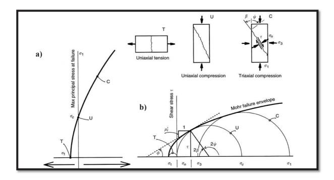
**Figure II.5:** *a)* Relation entre les contraintes principales lors d'une rupture, *b)* l'enveloppe de Mohr représentant la relation entre les contraintes et les paramètres de ruptures d'une roche. L'angle  $\beta = (-(\pi/2) - \psi)$  désigne l'angle entre la surface de rupture et la direction de la contrainte maximale compressive  $\sigma_1$  (Lockner & Beeler, 2002)
