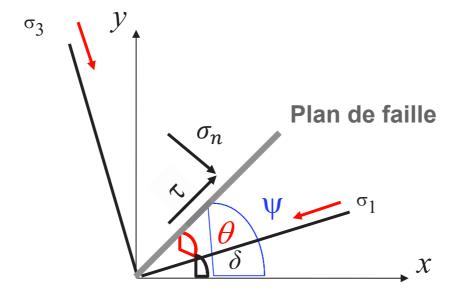
**Figure II.4**: Représentation géométrique des contraintes principale sur le plan de faille, la fonction de rupture de Coulomb nommée CFF n'est alors que la combinaison entre la contrainte normale  $\sigma_n$  multipliée par le coefficient de friction  $\mu$  et la contrainte de cisaillement (ou tangentielle)  $\tau$
