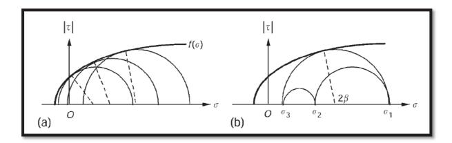
**Figure II.3** *a)*: courbe de rupture non linéaire (ou courbe intrinsèque), définie comme étant l'enveloppe de Mohr-Coulomb de tous les cercles de Mohr qui provoquent une rupture, *b)*: La construction du cercle de Mohr montrent que, selon l'hypothèse de Mohr, la contrainte principale intermédiaire n'influence pas sur le processus de rupture (d'après Jaeger & Cook, 1969 et Jaeger et al, 2009)
