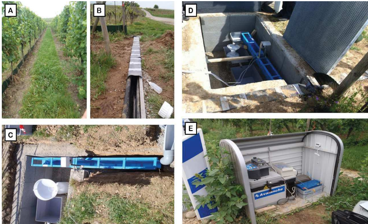
Figure 2-4 : Instrumentation présente sur les parcelles conventionnelle et biologique du bassin versant viticole. A) barrière en polyéthylène entre les parcelles, B) gouttière interceptant l'eau de ruissellement aux parcelles, C et D) canaux venturi et bidons de récupération des eaux de ruissellement, E) préleveur réfrigéré et débitmètre
