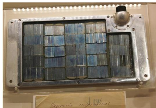
**Figure VI-3** : les premières cellules soviétiques à avoir volé dans l'espace ont servi à alimenter les instruments scientifiques de Spoutnik et le système de radio. Source : [www.yuri-gagarin.com](http://www.yuri-gagarin.com)
