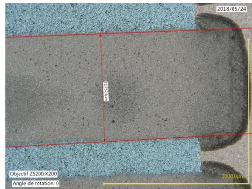
**Figure II-39** : la largeur d'une bande d'aluminium du motif C est en réalité de 750  $\mu\text{m}$ .
