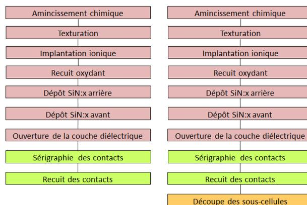
**Figure III-1** : procédure de fabrication de cellules PERC standard (à gauche), comparée à la fabrication de sous-cellules PERC (droite). Seule une étape de découpe est ajoutée en fin de procédé (back-end).
