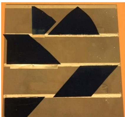
**Figure V-9 :** assemblage avec ruban de cuivre sur TinPad.
