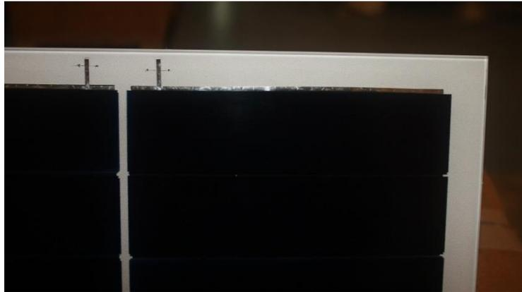
**Figure V-28** : les rubans verticaux sur la photographie (en haut) servent à la circulation du courant total généré par chaque chapelet. Les rubans horizontaux (disposés entre chaque sous-cellule) servent à la connexion des sous-cellules entre elles.
