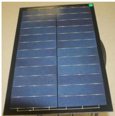
**Figure III-20 :** module réalisé avec des sous-cellules « finger droit ».
