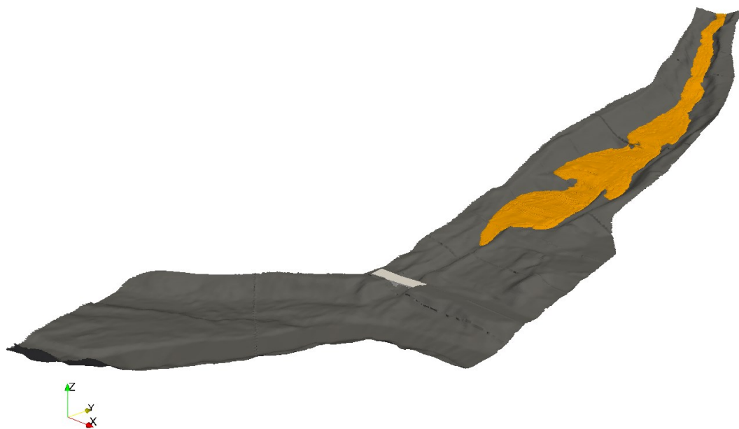
Figure 355 : Représentation de la surface libre de l'écoulement de la lave torrentielle : t = 252 s.
