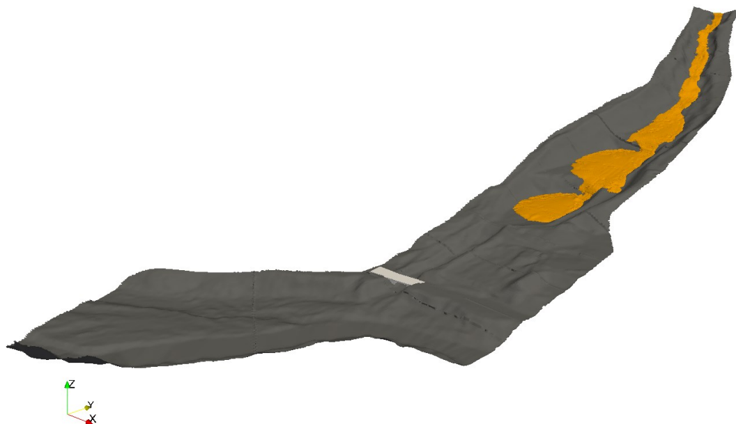
Figure 349 : Représentation de la surface libre de l'écoulement de la lave torrentielle : t = 40 s.
