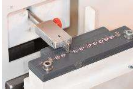
Figure 91 : montage expérimental pour la quantification des forces corono-apicales sur le bracket 5 sur une plaquette plane.
