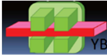
Figure 7: attache orthodontique ou bracket (en vert) disposant d'une gorge médiane dans laquelle un fil orthodontique est inséré (rouge) (courtoisie du Dr Y. Bolender).
