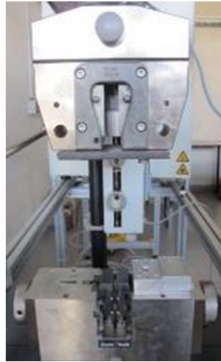
Figure 38: machine de traction normalisée (située à l'IUT Moselle-Est de Forbach) avec la cellule d'enregistrement de 10kN.
