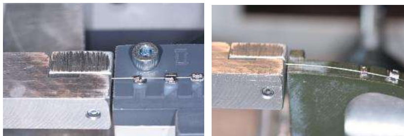
Figure 59 : pince pour les mesures des forces de frottement.
