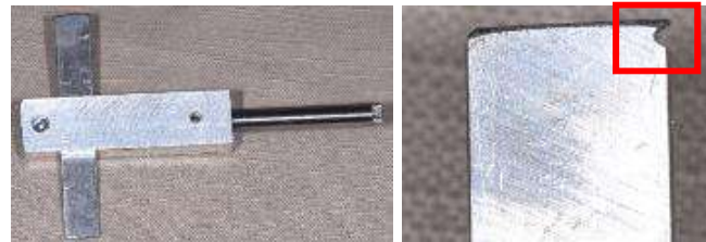
Figure 58 : second bec, plus long, servant pour les mesures des forces vestibulo-palatines ou horizontales.
