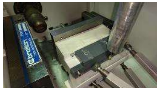
Figure 64 : essai en compression sur la machine de traction normalisée (Forbach) comparé aux essais en traction sur le banc de traction personnalisé pour la quantification des forces verticales ou corono-apicales sur l'attache N°5 positionné sur une plaquette plane en milieu humide à 35°C.
