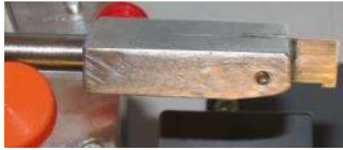
Figure 57 : vue d'ensemble des trois parties constituant la pièce de traction.
