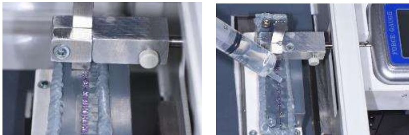
Figure 75 : évaluation des forces corono-apicales (ou verticales) en milieu sec et humide à 35°C sur les plaquettes planes.
