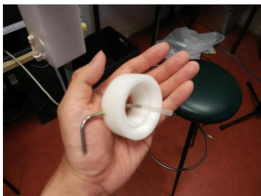
Figure III-1 Embout pour la mesure de la pression intra-orale (à gauche) et après installation au système EVA2 (à droite)
