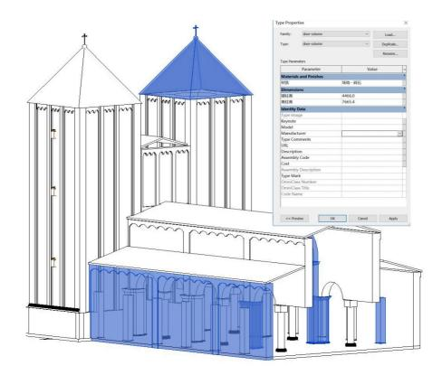
Figure 8. Visualisation 3D du modèle paramétrique HBIM final de l'Abbaye de Niedermunster et ses propriétés éditables
