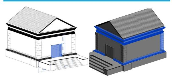
Figure 6. Modèles 3D obtenus à partir de modélisations paramétriques reposant sur des structures ruinées ("Petit Château du Meisenbach").
