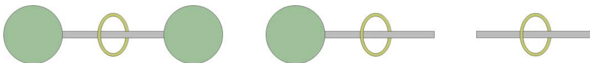
Figure 26. De g. à d. : représentation schématique d'un [2]rotaxane, d'un [2]semirotaxane et d'un [2]pseudorotaxane.
