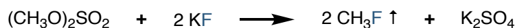
Figure 2.1 Première synthèse d'un composé organofluoré : le fluorure de méthyle par Dumas et al.
