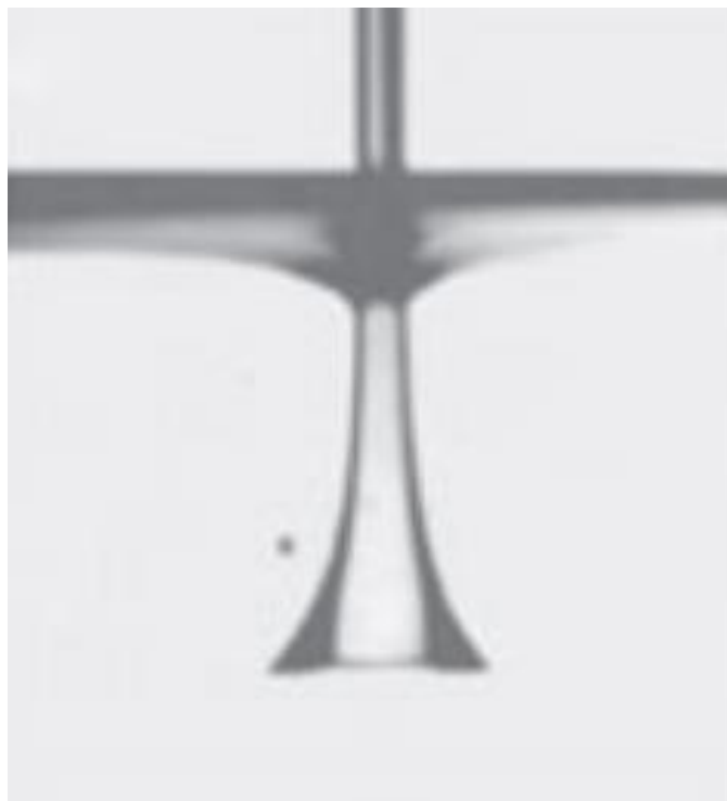
Figure 6 - Création d'une longue cavité d'air autour d'un jet liquide laminaire en plongeon. Source : Lorenceau, et al. (2004). Reproduite avec la permission de American Physical Society
