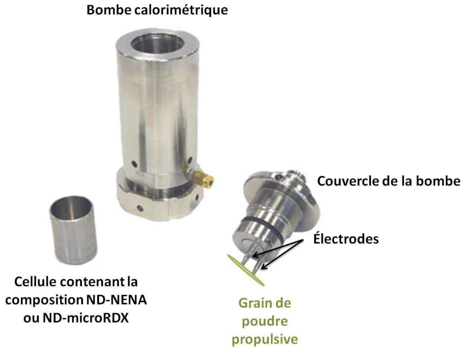
Figure V-2. Bombe calorimétrique « haute pression » C62 IKA 3265000. L'image provient du site Clarkson Laboratory.
