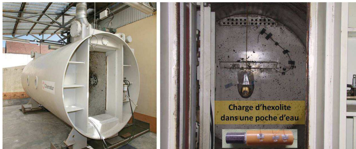
Figure II-1. Cuve de détonation de 9 m 3 (photographie de gauche). À l'intérieur, une charge d'hexolite RDX/TNT 60/40 (250 g) est suspendue dans une poche d'eau.
