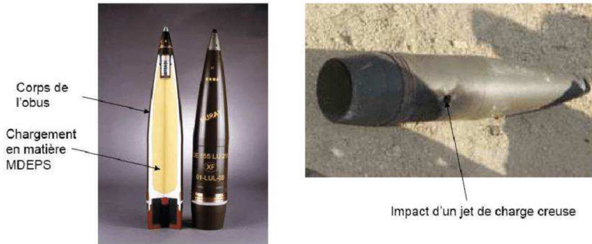
Figure I-4. L'impact d'un jet de charge creuse sur un obus de 155 mm LU211-IM n'a pas déclenché de réaction accidentelle, montrant le caractère insensible de la munition (Guillemin 2008), Matière Détonante Extrêmement Peu Sensible (MDEPS).
