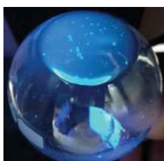
Figure 44 - Photo d'un liquide ionique à température ambiante, composé 05e exposé à une source d'UV
