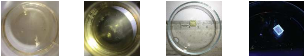
Figure 105 - Croissance d'un monocristal de matériaux ioniques luminescents (évolution sur 1 mois) ; à droite cristal d'environ 0,5 \text{ cm}^3 excité sous lumière UV (365 nm)
