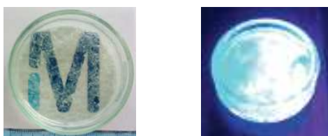
Figure 104 - Dispositif polycristallin à base du matériau 31d ; à droite sous excitation UV (365 nm)
