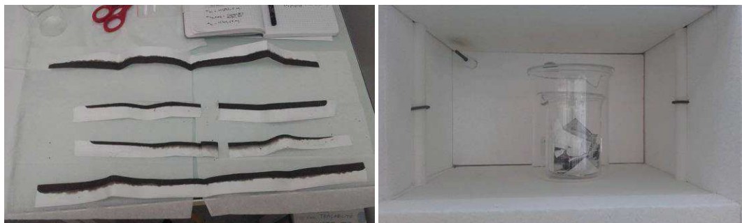
Figure 2-12 : Filtre contenant les a rosols atmosph riques particuliers (  gauche) et l' tape de calcination (  droite)
